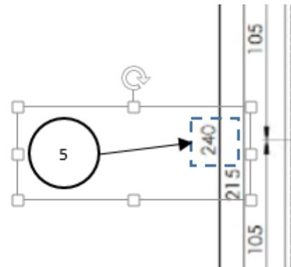
・Shiftキーを押しながら寸法付近で左クリックします。
