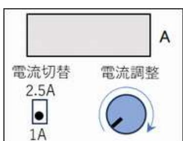
SOG に出力する電流を調整する部分です。電流切替スイッチは、2.5A と 1A で、それぞれ最大値となっています。
