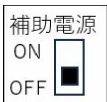
補助電源は、主電源スイッチが ON の時に動作します。
