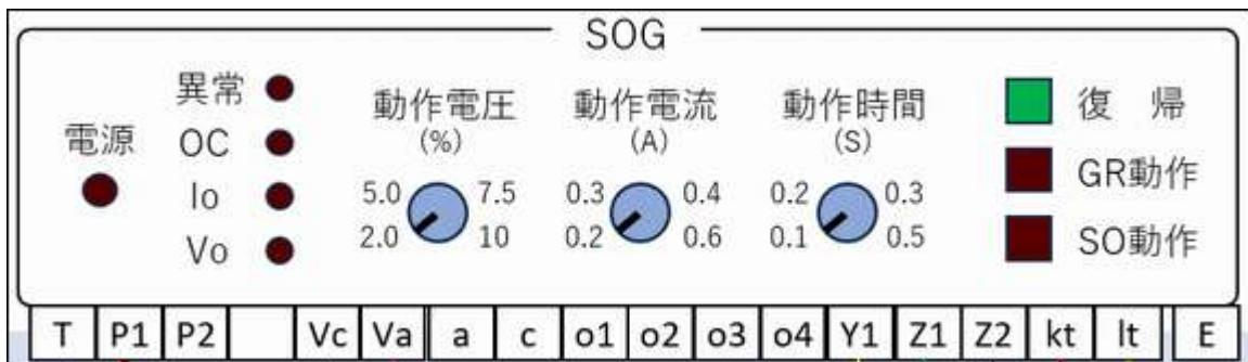
SOG では、P1,P2 端子を外して試験を行います。最初に P1,P2 端子をクリックする事で、最初に接続されている赤と黒のケーブルが離線されます。
