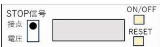
カウンターは、T1,T2 端子が正しく接続されている時に動作します。
