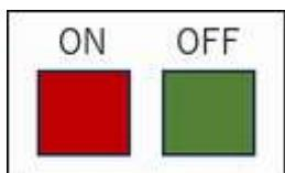
主電源スイッチが OFF の状態では、左の図のように ON ボタンも OFF ボタンも消灯した状態となります。主電源が ON になると、OFF ボタンが点灯します。
