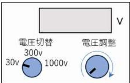
電圧調整は、30V, 300V, 1000V の切替スイッチがあり、それぞれが最大値となります。電圧調整のツマミは下にあるスライダーで回転させます。ツマミは3回転して Max となります。
