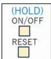
HOLD ボタンは、SOG が動作したときに、電流、電圧、位相の値表示をホールドします
