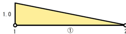
(c) FEM出力結果に基づく曲げモーメント図
